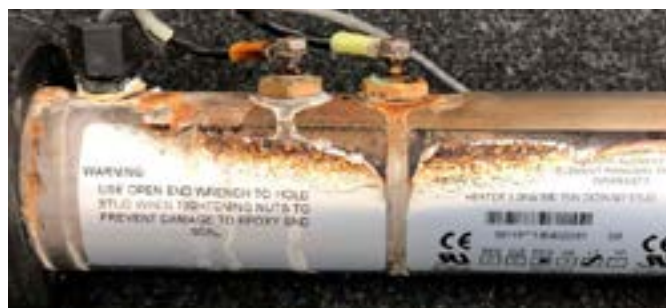
Eroderet varmelegeme med tærede pakninger.
